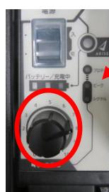
アンプ上部の 主音量は7~8に固定します。
